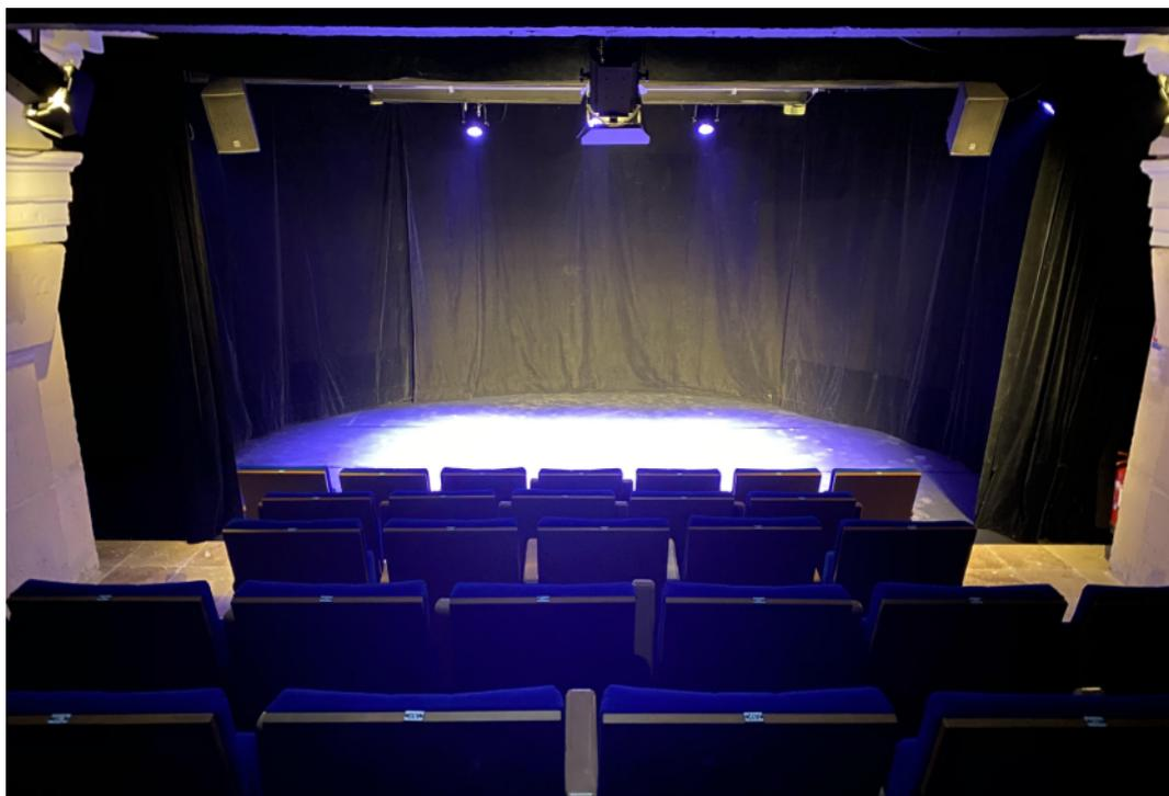
Espace scénique de 6,5m d'ouverture à la face - 4.6m de profondeur au centre couvert par un gril fixe de 7 tubes - 50mm de diamètre à 3,25m de hauteur - Plateau en demi-lune : voir plan
